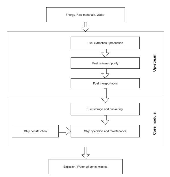
FIGURE 14 THE SYSTEM BOUNDARIES FOR LCA STUDY
